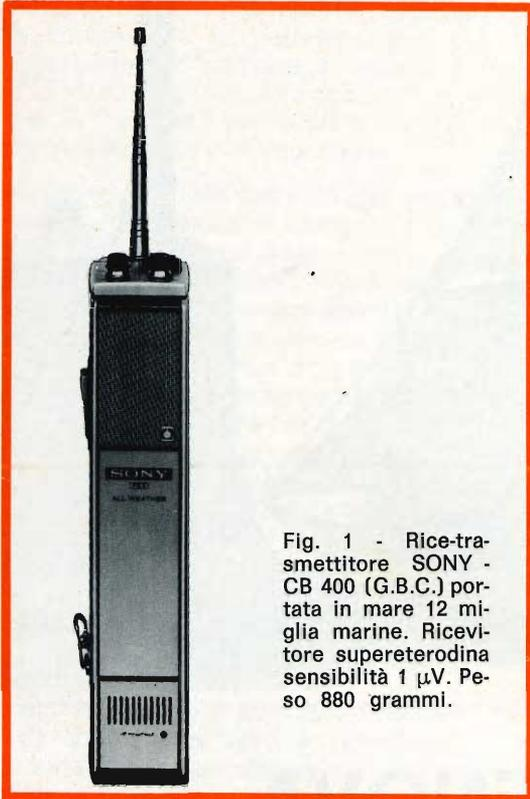
Fig. 1 - Rice-trasmettitore SONY - CB 400 (G.B.C.) portata in mare 12 miglia marine. Ricevitore supereterodina sensibilità 1  $\mu$ V. Peso 880 grammi.
